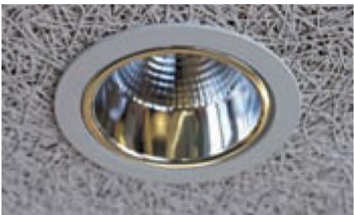
Точечные светильники диаметром до 150мм для плит Heradesign, макс. вес \leq 0,60 кг. Даунлайты диаметром до 200мм для плит Heradesign, макс. вес \leq 1,50 кг. В остальных случаях необходимы независимые подвесы!
